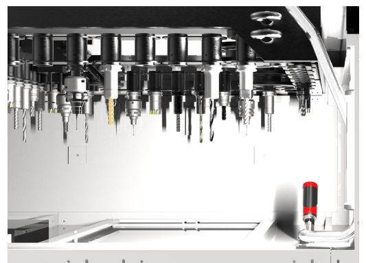
Werkzeugwechsellmagazin mit EAC 2.0
