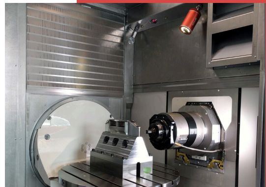
Einbau RWC 2.0 in 5-Achs-Fräsmaschine
