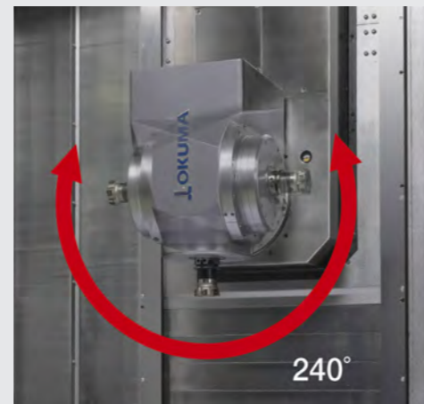
B-Achse mit Verfahrbereich 240°
