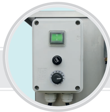
Stufenlose Regelung der Pumpengeschwindigkeit
